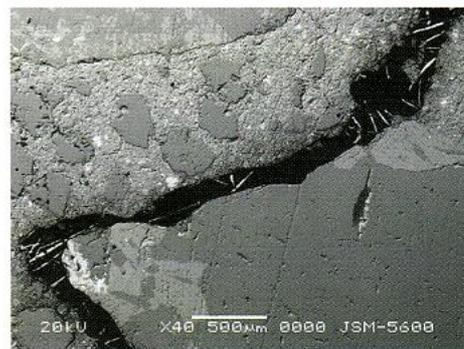
La "backscattered electron image" (BEI) mostra la crescita cristallina all'interno della microfessurazione ingrandita (campioni di carote provenienti dalle strutture interrate del Terminal 3 del nuovo aeroporto di Singapore, 150.000 m<sup>3</sup> di calcestruzzo trattato con il Penetron® Admix)
